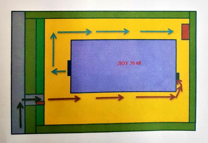
План-схема движения транспортных средств и детей при проведении дорожных ремонтно-строительных работ
